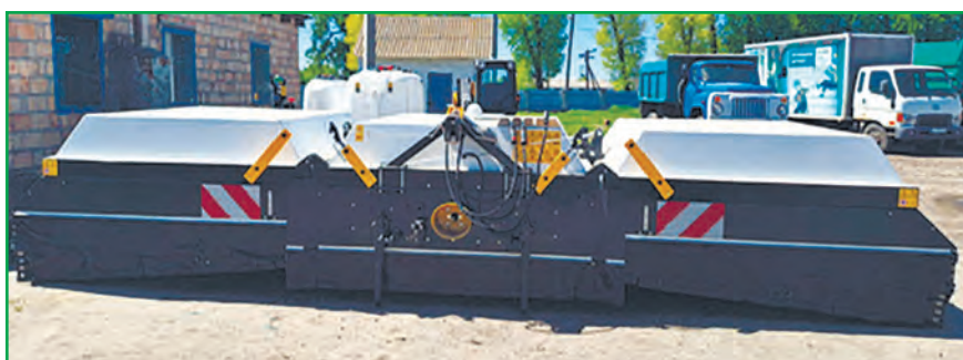
Рис. 2. Обприскувач з інтелектуальною системою вибіркового внесення гербіциду, Київська обл., 2024 р.
